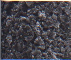
REM-Aufnahme der gröberen, porösen Papierbeschichtung.
